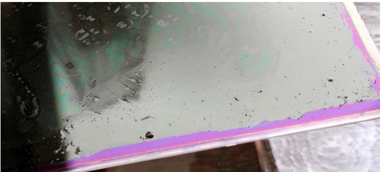
Bild 13: Flatpanel mit abgetrennter Glasplatte: Indium zwischen der Flüssigkristallschicht (feuchtes Aussehen) und der Glasplatte. Foto: Zepf 2018.
